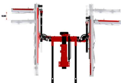
Elevación hidráulica simultánea de barras horizontal y vertical para terrazas
