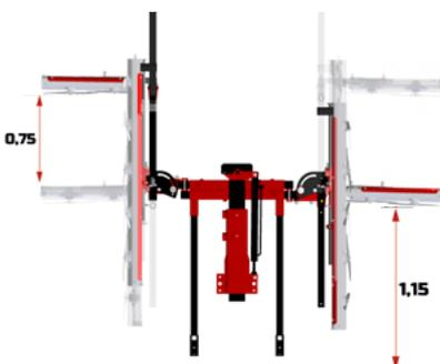
Sollevamento idraulico della barra orizzontale ideale per vigneti ad alberello e spalliera.
