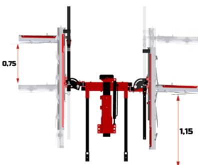
Elevation hydraulique du barre de coupe horizontale pour vignobles basse en gobelet et treille
