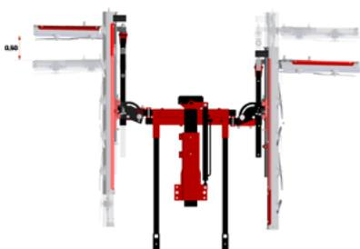
Elevation hydraulique simultanée des barres horizontales et verticales idéal pour terrains a terrasse
